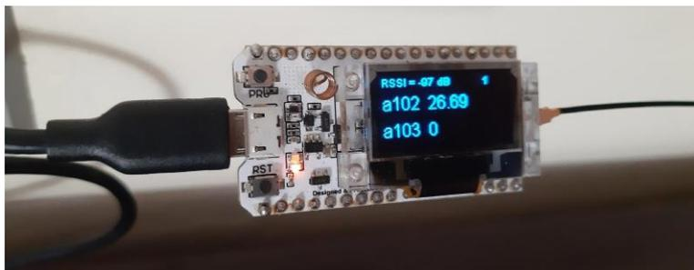
Figura 9 – Dispositivo *central*, utilizado para receber os dados e conectar-se à internet
