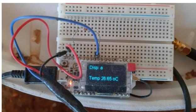
Figura 8 – *Dispositivo a*, utilizado no local da medição de temperatura e umidade
