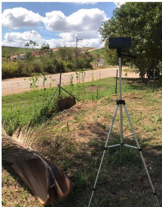
**Figura 3** – Equipamento utilizado para levantamento de tráfego
