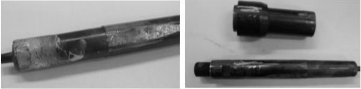
Figura 3 - Macho vareta empenado (a) e Macho vareta desgastado (b) Fonte: Dos autores (2017).
