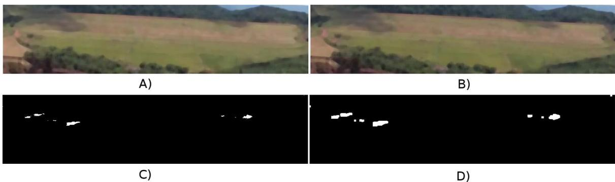
**Figura 4** - (A) Região de interesse do *frame* A pré-processado; (B) Região de interesse do *frame* B pré-processado; (C) Diferença binarizada entre a região de interesse do *frame* A e região de interesse do *frame* B; (D) Diferença dilatada binarizada entre regiões de interesse dos *frames* A e B.
